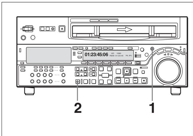
**1** Schalten Sie die RECORDER-Taste durch Drücken ein.
