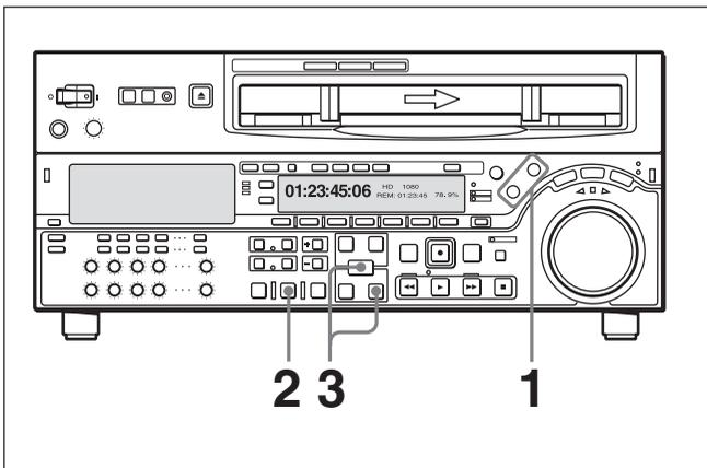
**1** Wählen Sie den zu betätigenden Videorecorder, indem Sie die entsprechende Taste (PLAYER oder RECORDER) durch Drücken der Recorder-Taste einschalten. Suchen Sie dann den gewünschten IN-Punkt auf und stoppen Sie den Bandlauf an dieser Stelle. Wiederholen Sie den gleichen Vorgang für den anderen Videorecorder.
