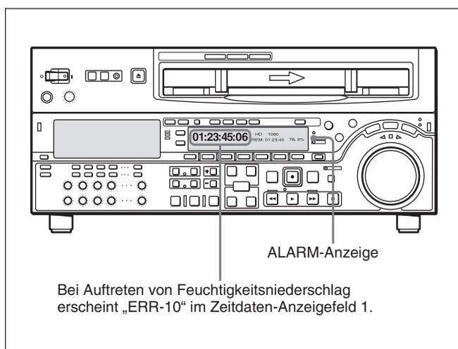
Wenn sich Feuchtigkeit im Geräteinneren angesammelt hat, kommen die Motoren von Kopftrommel und Capstan zum Stillstand, und die Cassette wird automatisch ausgeworfen. Danach beginnt die Kopftrommel erneut zu rotieren, um ihre Oberfläche zu trocknen. In diesem Zustand ist das Gerät nicht betriebsfähig. Sobald die Feuchtigkeit verdunstet ist, verschwindet die Fehlermeldung, und die ALARM-Anzeige erlischt.
