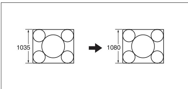
**1035 ⇒ 1080 (PANEL):** Umwandlung der aktiven Abtastzeilen von 1035 auf 1080. Einfügen der 1035 Zeilen in 1080 und dann horizontales Komprimieren.
