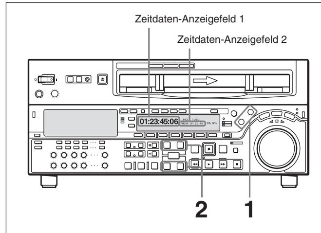
**1** Drücken Sie die RECORDER- oder die PLAYER-Taste zur Wahl des Gerätes, dessen Schnittpunkt überprüft werden soll.
