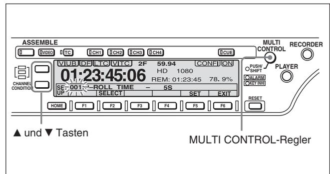
Wenn die Menü-Parameter-Nummer auf der Menü-Anzeige blinkt, können Sie den Parameter durch Drehen des MULTI CONTROL-Reglers einstellen. Um von einer Parametergruppe zur nächsten oder vorherigen umzuschalten, verwenden Sie die ▲ und ▼ Tasten.
