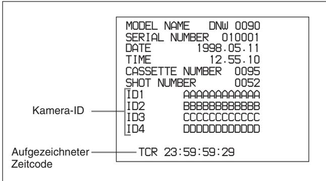
Der Inhalt der Shot-Daten-Anzeige richtet sich nach den Aufnahmebedingungen. Bandabschnitte, in denen aufgrund von Kamerawechsel keine Shot-Daten aufgezeichnet wurden, bleiben leer.
