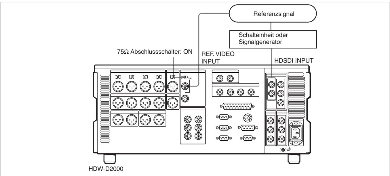
**• Anschlüsse für Aufnahme von einem externen Videorecorder (Zuspielgerät)**
