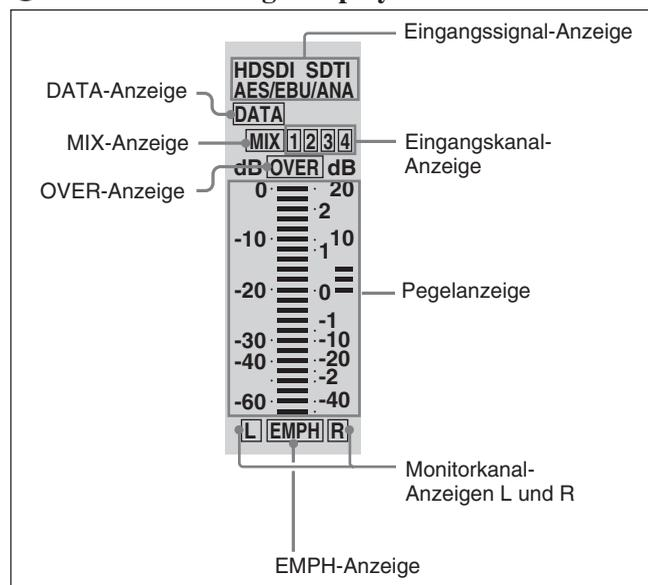
**Eingangssignal-Anzeige:** Zeigt das gegenwärtig gewählte Eingangssignal für den Audiokanal an (HDSDI, SDTI, AES/EBU oder ANA für analog).
