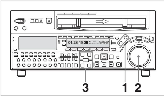
**1** Pressez la touche RECORDER ou PLAYER pour sélectionner le magnétoscope sur lequel le seuil de montage sera posé.
