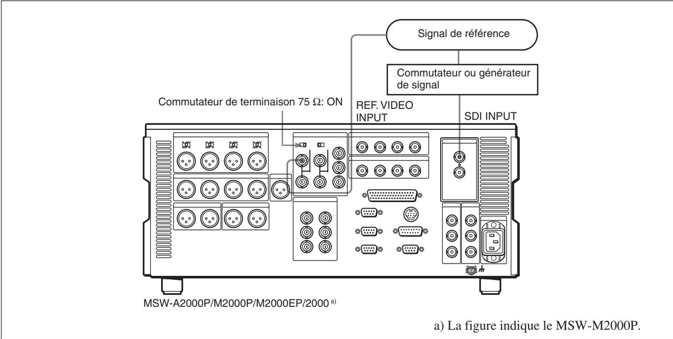
• Connexion pour l'enregistrement à partir d'un magnétoscope extérieur (lecteur)
