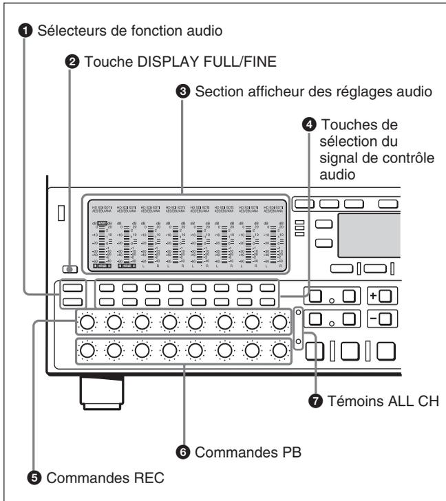
Dans la section de contrôle audio, vous pouvez sélectionner et afficher des signaux d'entrée et de sortie pour les canaux audio 1 à 8.
