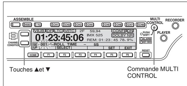
Le numéro du poste de menu apparaissant sur l'afficheur des menus clignote, il est possible de changer de poste de menu en tournant la commande MULTI CONTROL.
