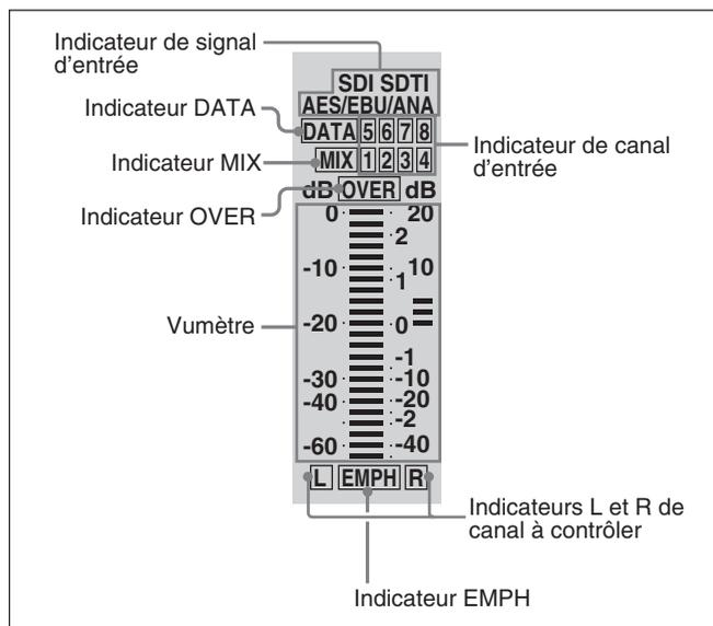
**Indicateur de signal d'entrée:** Indique le signal d'entrée actuellement sélectionné ('SDI', 'SDTI', 'AES/EBU', 'ANA' pour analogique) pour le canal d'entrée audio correspondant.
