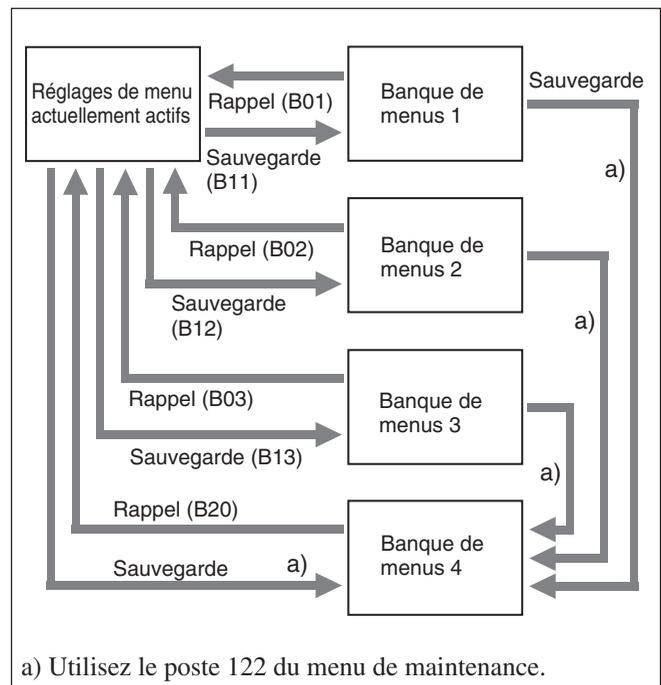
Les réglages du menu d'implantation actuellement actifs, ainsi que les réglages sauvegardés dans les banques de menus, sont stockés dans des zones de stockage séparées pour les modes 525 lignes et 625 lignes.
