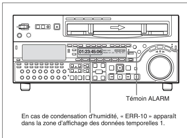
Dans ce cas, les moteurs du tambour et du cabestan s'arrêtent, et la cassette est automatiquement éjectée. Le tambour se remet alors à tourner pour sécher sa surface. Dans cet état, l'appareil est inutilisable. Une fois l'humidité évaporée, le message d'erreur disparaît et le témoin ALARM s'éteint.
